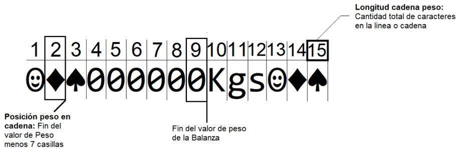
Con el cálculo ya listo de la longitud de la cadena y posición del peso se deben ingresar los siguientes datos:
